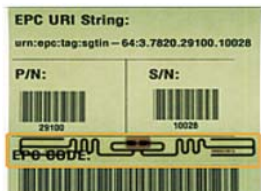
附有條碼的RFID標籤嵌有晶片以及感測用的天線(橘色框內)
