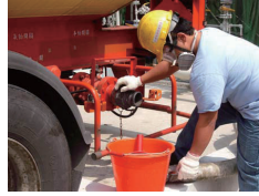
圖三 工作人員配戴安全配備進行槽車卸料程序
