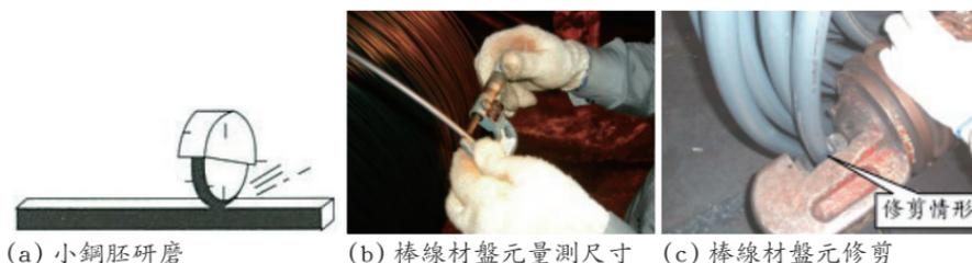
▲圖八 鋼胚與棒線盤元精整
