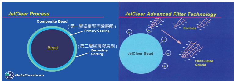
▲圖二：精密型自動過濾器過濾介質及凝聚吸附方式示意圖
