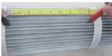
濾袋表面通常是塗層鋁材質或加入金屬線，以提升導電能力，降低電阻，減少靜電的累積。
