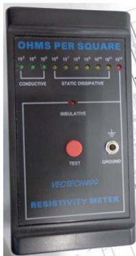
電阻率儀量測濾袋表面電阻，依文獻資料記載其表面電阻需低於  $500\Omega$  才能發揮抗靜電的效果。
