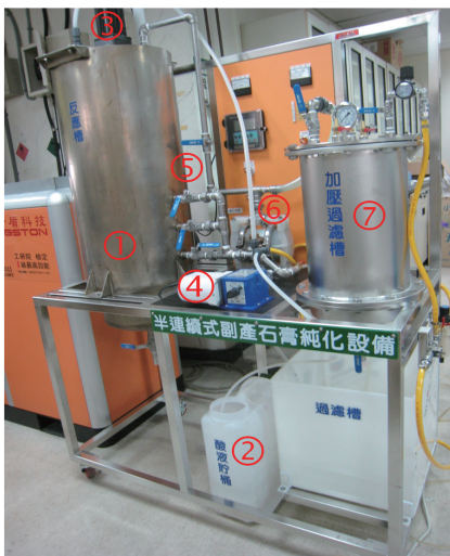
▲圖4：副產石灰轉換二水硫酸鈣之實驗室測試機： ①反應槽；②酸液儲槽；③pH計；④加酸用泵； ⑤溢流閥；⑥抽取過濾液暨加壓泵；⑦加壓過濾槽
