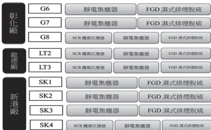
圖五 台化各廠區汽電共生機組所採用之污染防制設備
